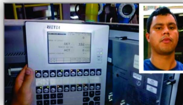
Por iniciativa própria, o colaborador Edvaldo Augusto recuperou um Painel Indicador de fabricação alemã, usado nos cortadores. Este equipamento é de vital importância para a operação de cortadores, de difícil aquisição, alto custo e sua venda foi interrompida no mercado por tempo indeterminado. E foi através da reutilização de componentes de outros painéis danificados e de mesmo modelo, que o Edvaldo conseguiu recuperar o equipamento, que já voltou para produção da fábrica M&G Polímeros.
